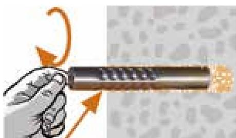
D Hülse mit Drehbewegung einsetzen. Optische Kontrolle der Füllmasse. Während der Aushärtungszeit die Hülse nicht bewegen.
